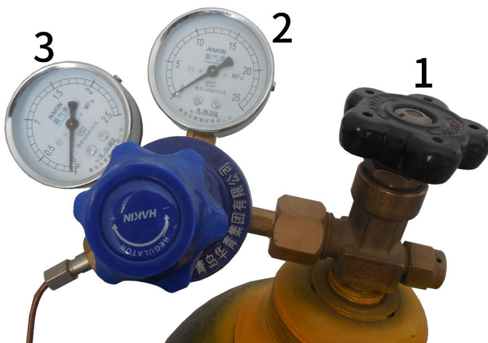
1. 总压阀 2. 总压表 3. 分压表 0.4MPa
